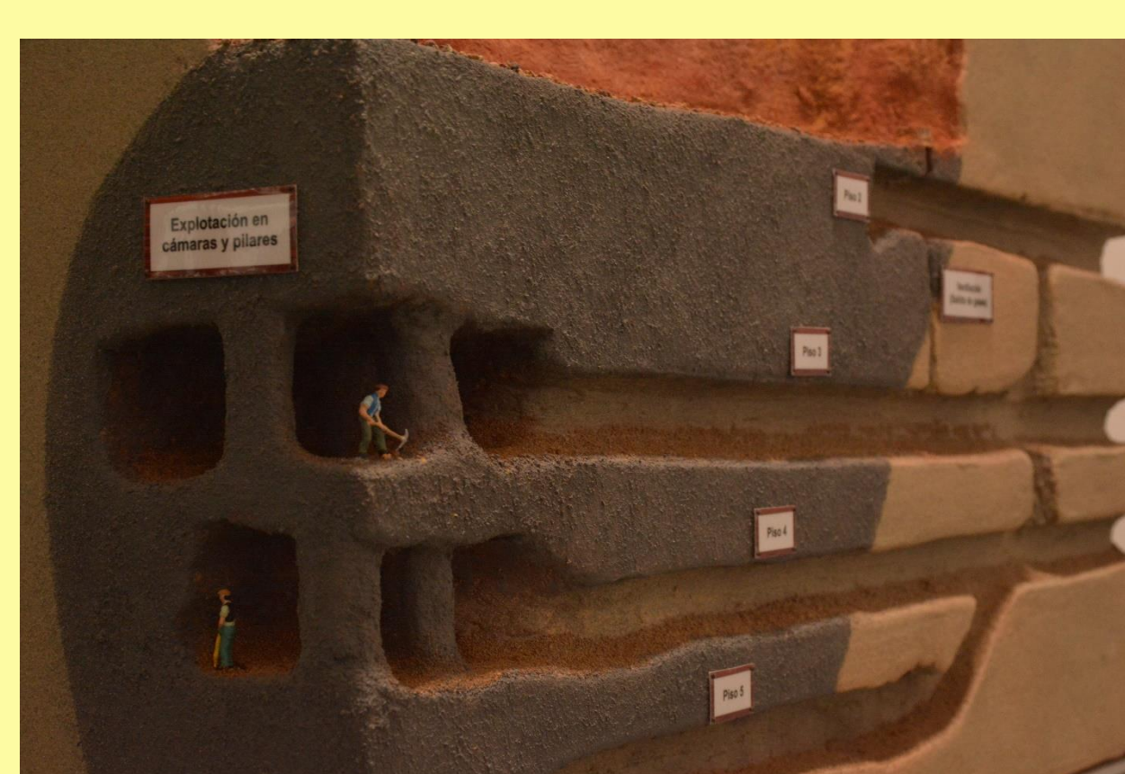
Explotación de la mineralización en cámaras y pilares
