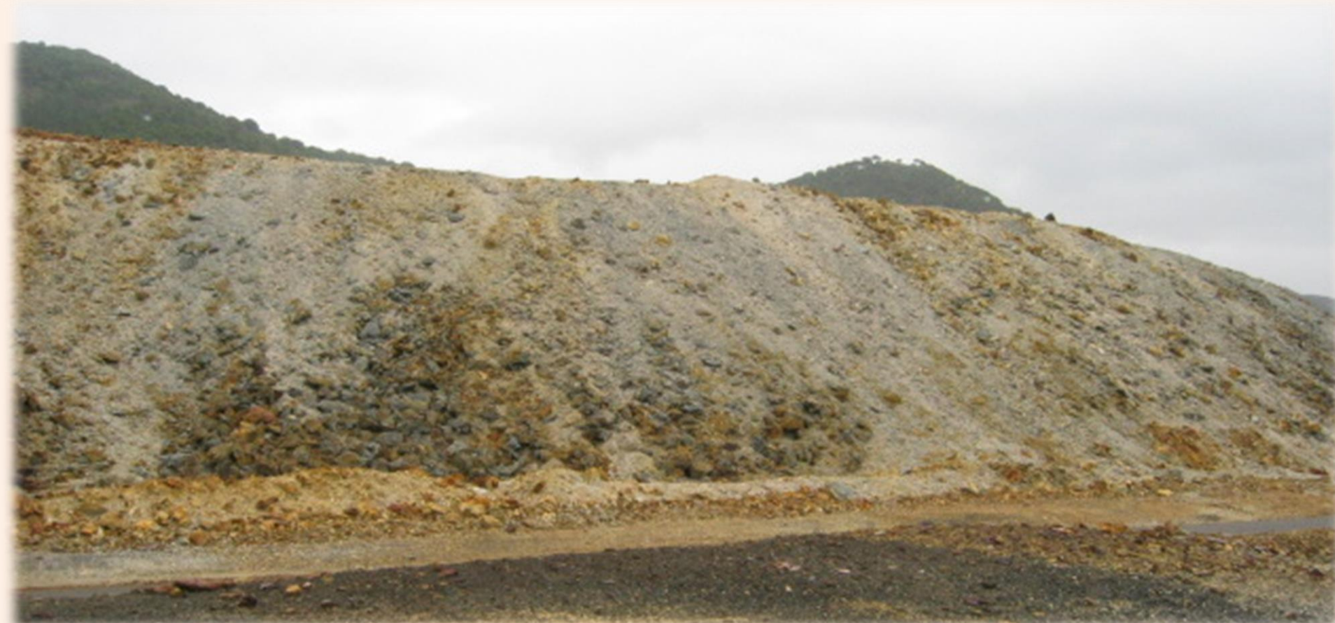
Escombreras de tobas (estériles): contienen restos de pirita y son fuente de aguas ácidas.
